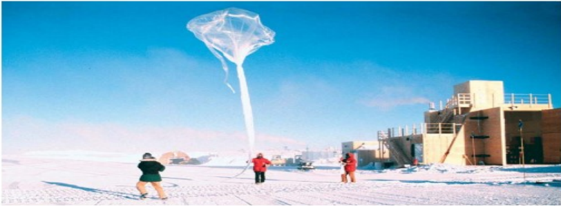
ပုံ - ၅ လေထုအတွင်း အိုဇုန်းပါဝင်မှု တိုင်းတာပုံ
