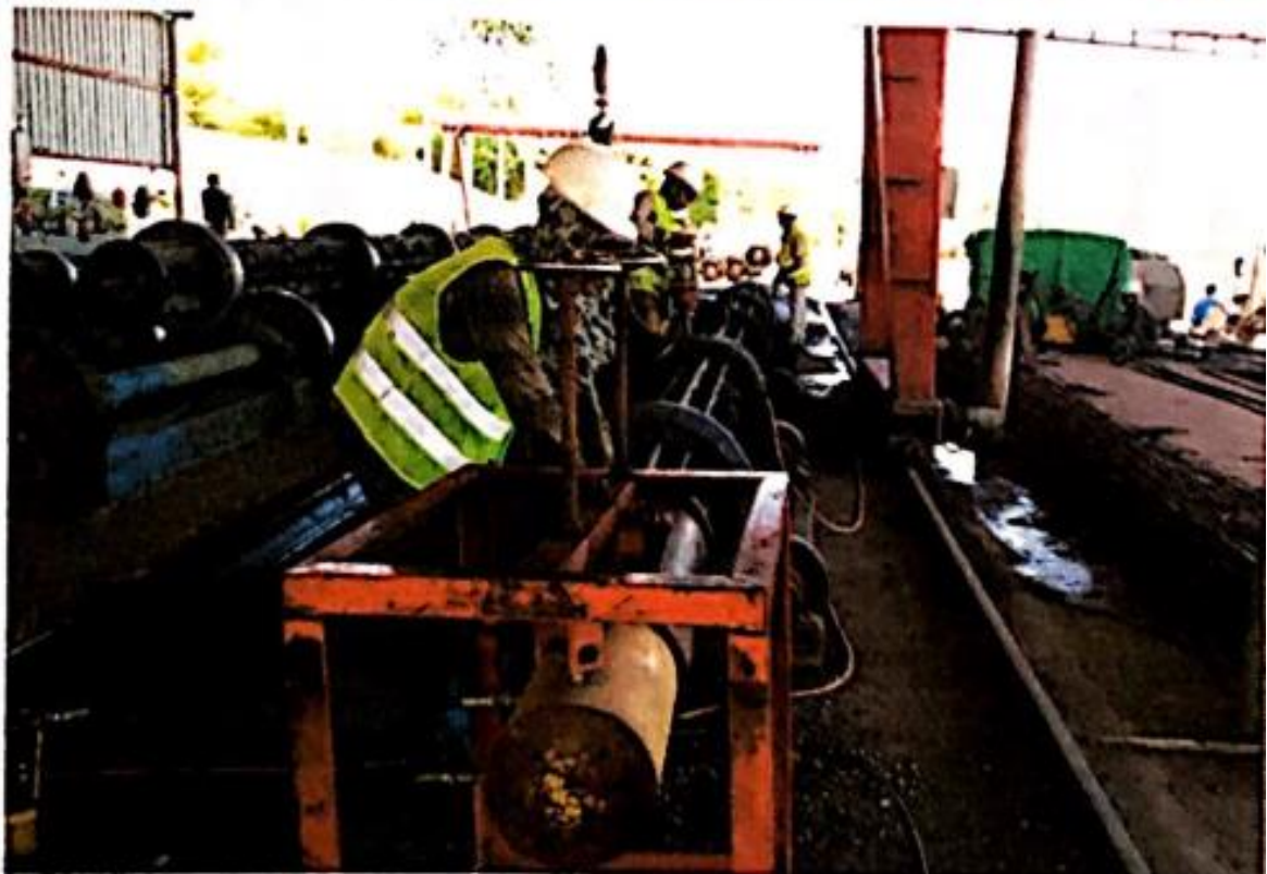
ပြုလုပ်ပြီးသား ကျောရိုးသံချောင်းများကို ဖလမ်းတပ်၍ ခေါင်းလုံး Rappid ပြုလုပ်ပြီး သံချည်သံကွေးပြုလုပ်ခြင်း
