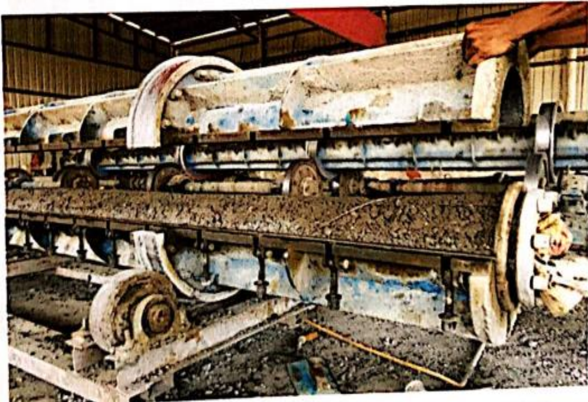
တိုင်ပုံ (Pole) ပြုလုပ်ပြီး သံမဏိမို(Steel Mould) အပေါ်ဖုံးဖြင့် ဖုံးအုပ်တပ်ဆင်ခြင်း
