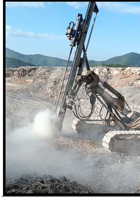
(၂) Crawler Drill ဖြင့် မိုင်းတွင်းတူးဖောက်ခြင်း
