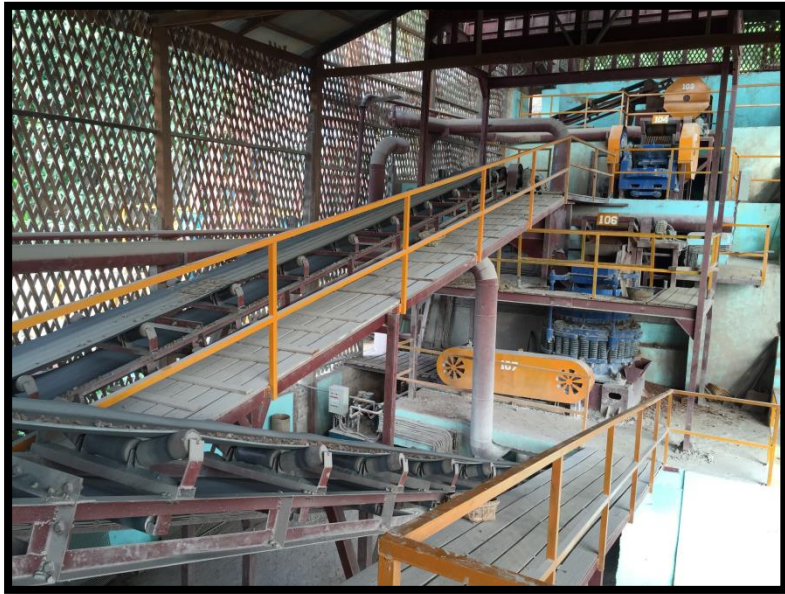
Jaw Crusher, Cone Crusher တို့ဖြင့် ကြိတ်ခွဲနေပုံ
