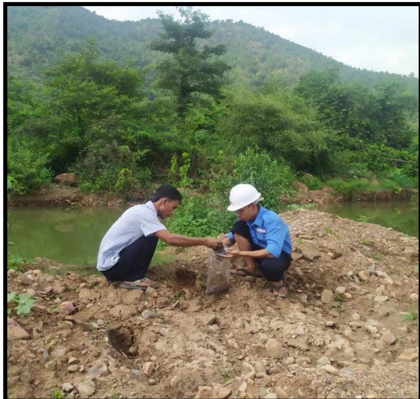
တူးဖော်ရေးလုပ်ကွက် အပေါ်ယံမြေစာပုံ မြေနမူနာ ကောက်ယူနေပုံ
