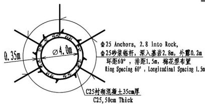
III类围岩B型衬砌断面 rock support class II
