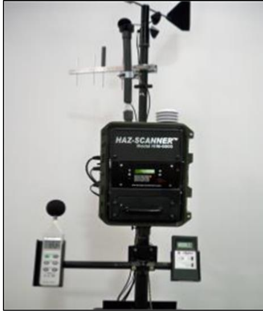
ပုံ(၅-၁၁) လေထုအရည်အသွေးတိုင်းတာရာတွင်အသုံးပြုသော HAZ-Scanner™ Model -EPAS1
