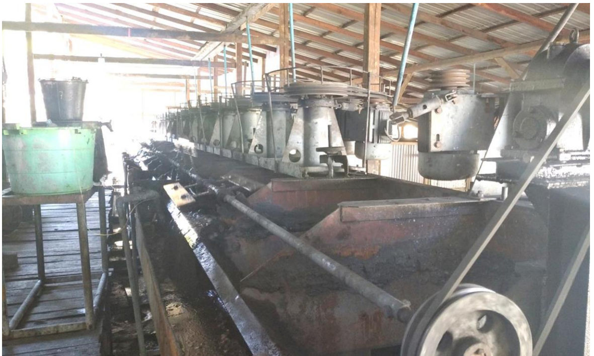
Floataion Cell သတ္တုများကို အမြုပ်များအနေဖြင့်ခတ်ထုတ်နေပုံ
