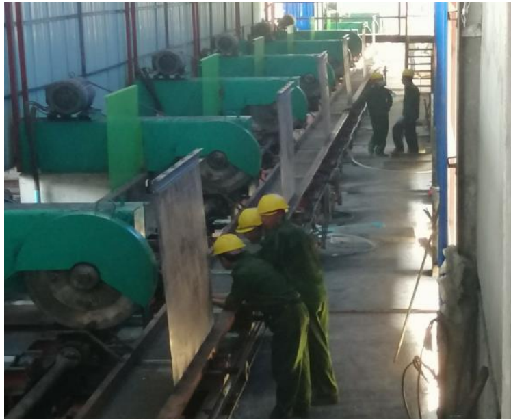
Figure 5.27 ဖြောင့်စက်မှ U Beam ဖြတ်စက်သို့ရောက်
