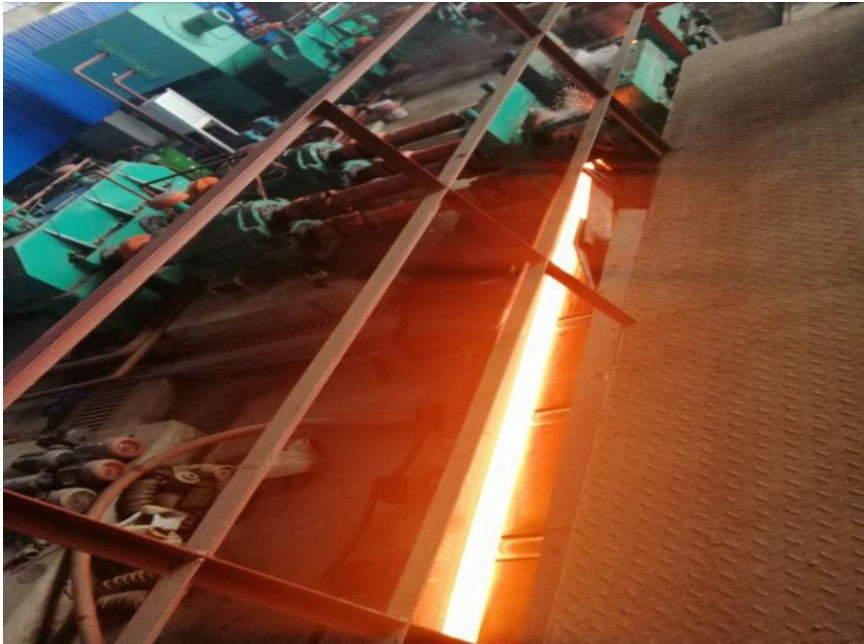
Figure 5.23 နန်းဆွဲတတိယအဆင့် U Beam စက်သို့ဖြတ်
