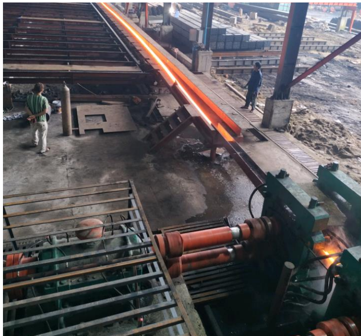
Figure 5.24 U Beam စက်သို့ဖြတ်ပြီး U Beam ချောင်းဖြစ်ပေါ်လာပုံ
