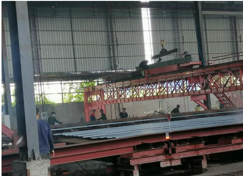
Figure 5.25 ထွက်လာသော U Beam ချောင်း ပါကင်စင်ပေါ်သို့ရောက်
