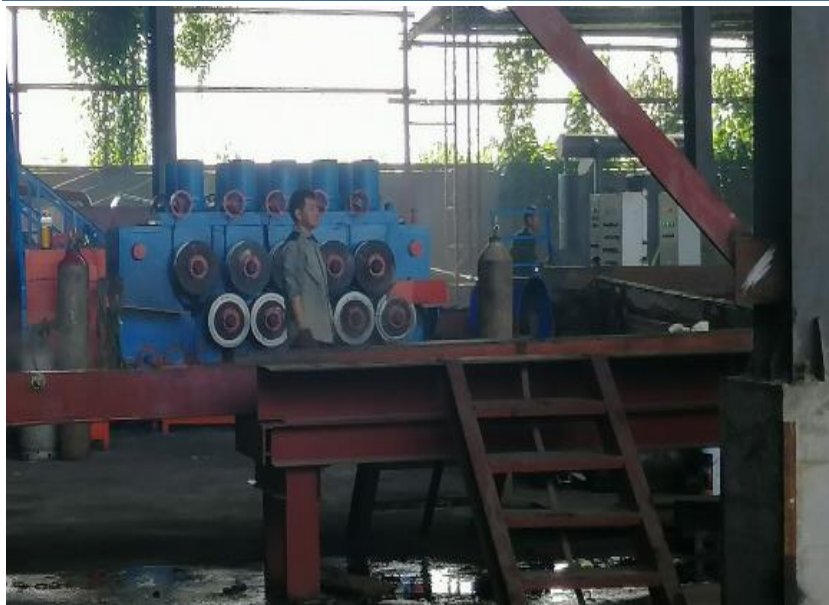
Figure 5.26 ပါကင်စင်ပေါ်မှ U Beam ဖြောင့်စက်သို့ဖြတ်
