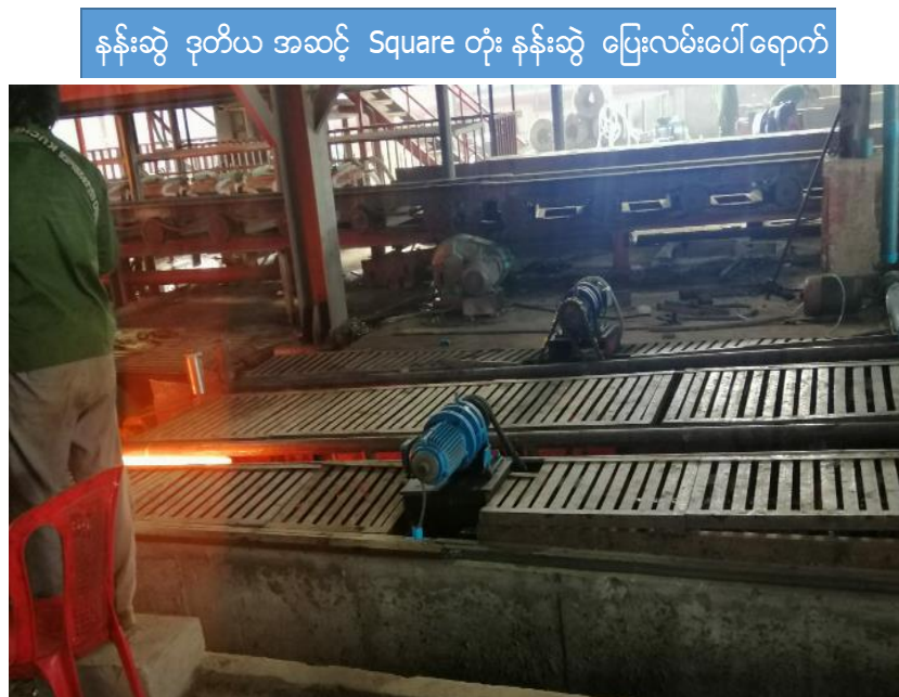
Figure 5.22 နန်းဆွဲ ဒုတိယ အဆင့် square တုံး နန်းဆွဲ ပြေးလမ်းပေါ်ရောက်
