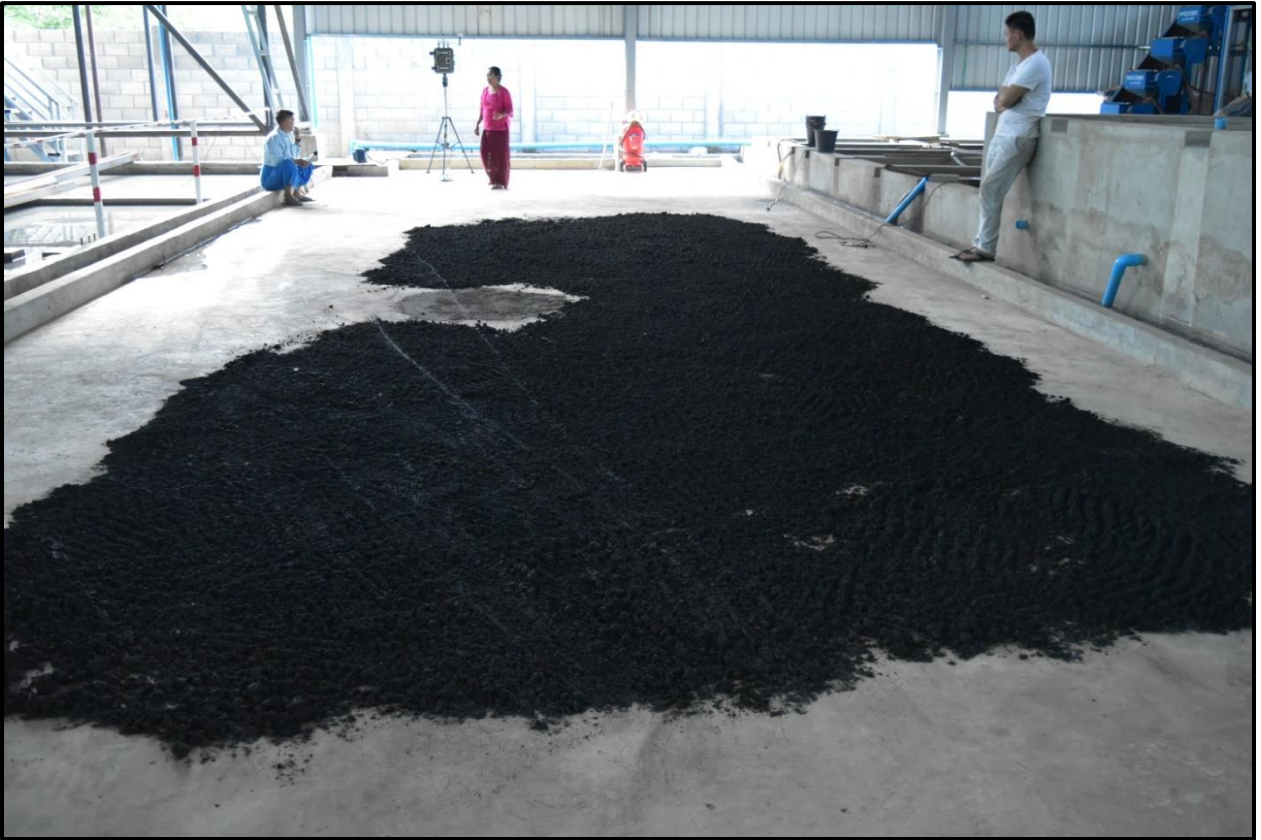
ပုံ(၈) ခဲမဖြူ-အဖြိုက်နက်ရောရာသတ္တုသန့်စင်(Tin-Tungsten Mix Concentrate)
