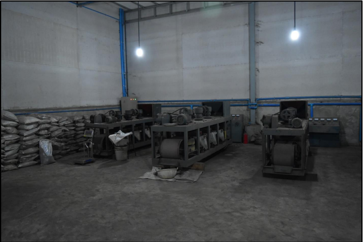
ပုံ(၉) ခဲမဖြူ-အဖြိုက်နက်ရောရာသတ္တုသန့်စင်မှ ခဲမဖြူသတ္တုသန့်စင်နှင့် အဖြိုက်နက် သတ္တုသန့်စင်ခွဲထုတ်သန့်စင်သည့် Dry Magnetic Separator
