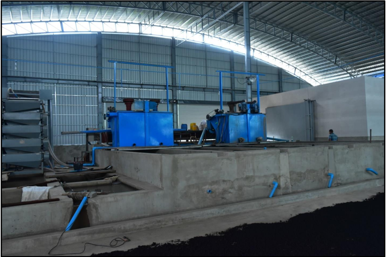
ပုံ(၄) ခဲမဖြူ-အဖြိုက်နက်သတ္တုရိုင်းများမှ ရှီးလိုက်သတ္တုရိုင်းများအား ဖယ်ရှားပေးသည့် အလေးစီးသတ္တုသန့်စင်စက်(Jig Concentrator)(ဒေါင်လိုက်မွှေစက်)
