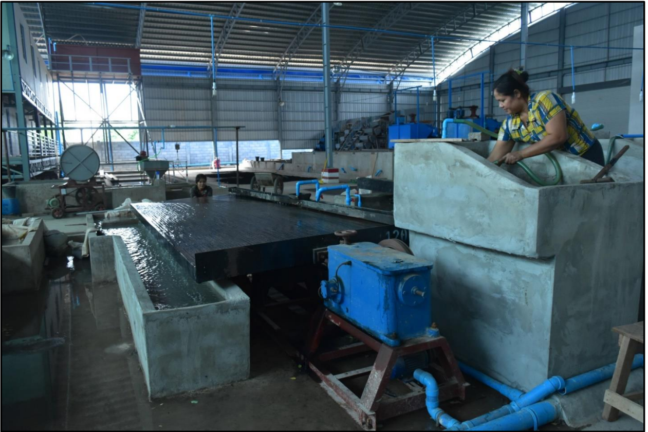
ပုံ(၆) ခဲမဖြူ အဖြိုက်နက်ရောရာသတ္တုရိုင်းများအား လှုပ်စားပွဲဖြင့် ထပ်မံသန့်စင်နေပုံ လှုပ်စားပွဲ သတ္တုသန့်စင်စက်(Shaking Table)
