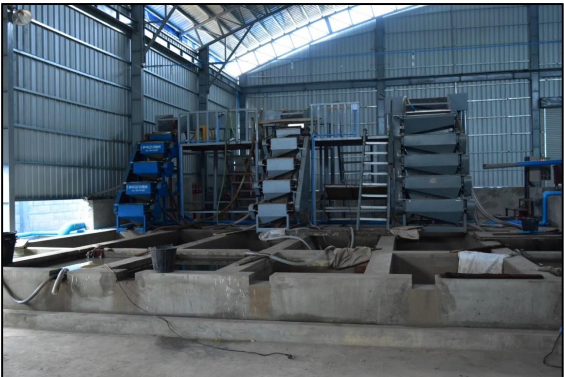
ပုံ(၃) ခဲမဖြူ-အဖြိုက်နက်ရောရာသတ္တုရိုင်းများအား ရေသံလိုက်ဖြင့် ခွဲထုတ်သန့်စင်ခြင်း (Wet Magnetic Separator)
