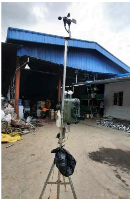
HAZ-SCANNER™ Model-EPAS ဖြင့် လေထုအရည်အသွေးတိုင်းတာခြင်း
