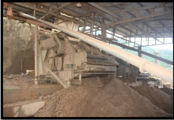
Figure 3.10 ဇကာအဆင့်ဆင့်ရွေးချယ်ခြင်း - သတ္တုခွဲခြားရေးတွင် အဆင့်နှစ်ဆင့်ပါ တုန်ခါစက်ကို အသုံးပြုပါသည်။ မြေနှင့်သတ္တုရောနေသည့် ခမီလီမီတာထက်သေးငယ်သော အရည်ပျစ်များကို ဆေးကြော၍ တုန်ခါမှုအဆင့်ဆင့်ဖြင့် လှုပ်ခါနေသော စားပွဲကိုသုံး၍ သတ္တုအရည်အနည်ကို ရစေပါသည်။ သတ္တုအရည်အနည်ရစေရန် ဓာတုပစ္စည်းများ အသုံးမပြုပါ။
