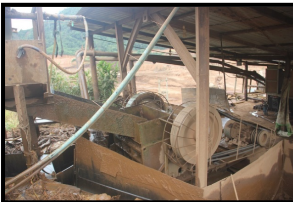
Figure 3.8 အရွယ်အစားခွဲခြားခြင်း- ဆေးကြောပြီးအရာများကို အရွယ်အစားခွဲခြားရန်အတွက် ထုလုံးရှည် ကျောက်ခွဲစက်သို့ပို့ပါသည်။ အရွယ်အစားကြီးသောထုလုံးရှည် ကျောက်ခွဲစက်၏အပေါ်ဆုံး အပိုင်းရှိ အရွယ်အစားခွဲစက်သည် တွင်းထွက်မြေစာများကို အရွယ်အမျိုးမျိုးခွဲခြားပေးပြီးအောက်ရှိ အရွယ်အစားခွဲ စားပွဲပေါ်သို့ပို့ပေးပုံ။
