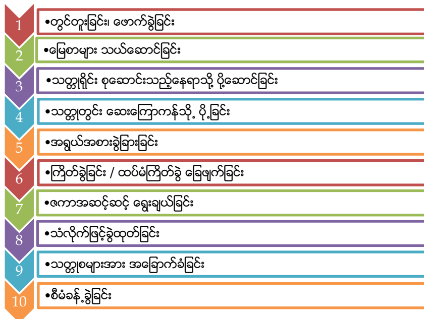
Figure 3.4 သတ္တုစမ်းသပ်ရန် လွန်တွင်းတူးခြင်း
