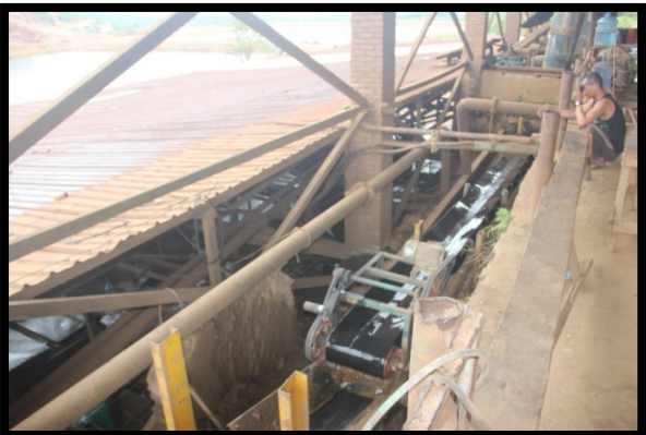
Figure 3.8 အရွယ်အစားခွဲခြားခြင်း- ဆေးကြောပြီးအရာများကို အရွယ်အစားခွဲခြားရန်အတွက် ထုလုံးရှည် ကျောက်ခွဲစက်သို့ပို့ပါသည်။ အရွယ်အစားကြီးသောထုလုံးရှည် ကျောက်ခွဲစက်၏အပေါ်ဆုံး အပိုင်းရှိ အရွယ်အစားခွဲစက်သည် တွင်းထွက်မြေစာများကို အရွယ်အမျိုးမျိုးခွဲခြားပေးပြီးအောက်ရှိ အရွယ်အစားခွဲ စားပွဲပေါ်သို့ပို့ပေးပုံ။
