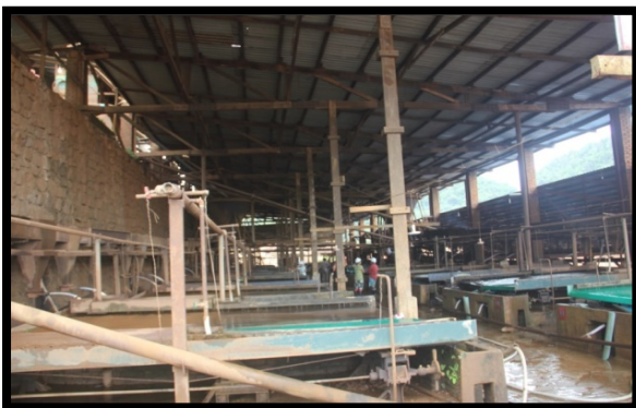
Figure 3.10 ဇကာအဆင့်ဆင့်ရွေးချယ်ခြင်း - သတ္တုခွဲခြားရေးတွင် အဆင့်နှစ်ဆင့်ပါ တုန်ခါစက်ကို အသုံးပြုပါသည်။ မြေနှင့်သတ္တုရောနေသည့် ခမီလီမီတာထက်သေးငယ်သော အရည်ပျစ်များကို ဆေးကြော၍ တုန်ခါမှုအဆင့်ဆင့်ဖြင့် လှုပ်ခါနေသော စားပွဲကိုသုံး၍ သတ္တုအရည်အနည်ကို ရစေပါသည်။ သတ္တုအရည်အနည်ရစေရန် ဓာတုပစ္စည်းများ အသုံးမပြုပါ။
