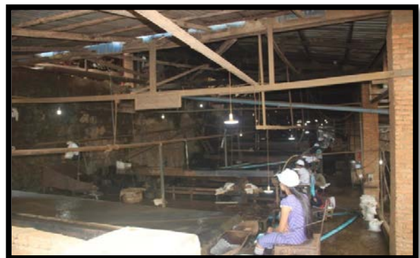
Figure 3.10 ဇကာအဆင့်ဆင့်ရွေးချယ်ခြင်း - သတ္တုခွဲခြားရေးတွင် အဆင့်နှစ်ဆင့်ပါ တုန်ခါစက်ကို အသုံးပြုပါသည်။ မြေနှင့်သတ္တုရောနေသည့် ခမီလီမီတာထက်သေးငယ်သော အရည်ပျစ်များကို ဆေးကြော၍ တုန်ခါမှုအဆင့်ဆင့်ဖြင့် လှုပ်ခါနေသော စားပွဲကိုသုံး၍ သတ္တုအရည်အနည်ကို ရစေပါသည်။ သတ္တုအရည်အနည်ရစေရန် ဓာတုပစ္စည်းများ အသုံးမပြုပါ။
