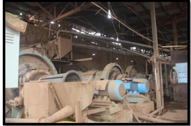
Figure 3.10 ဇကာအဆင့်ဆင့်ရွေးချယ်ခြင်း - သတ္တုခွဲခြားရေးတွင် အဆင့်နှစ်ဆင့်ပါ တုန်ခါစက်ကို အသုံးပြုပါသည်။ မြေနှင့်သတ္တုရောနေသည့် ခမီလီမီတာထက်သေးငယ်သော အရည်ပျစ်များကို ဆေးကြော၍ တုန်ခါမှုအဆင့်ဆင့်ဖြင့် လှုပ်ခါနေသော စားပွဲကိုသုံး၍ သတ္တုအရည်အနည်ကို ရစေပါသည်။ သတ္တုအရည်အနည်ရစေရန် ဓာတုပစ္စည်းများ အသုံးမပြုပါ။
